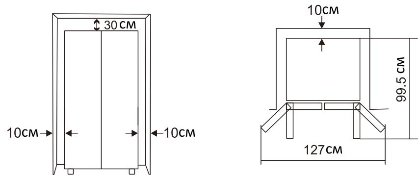
Пол помещения установки должен быть ровным, прочным и сухим. Если пол неровный, установите и закрепите регулируемые ножки, чтобы избежать вибрации и шума.
