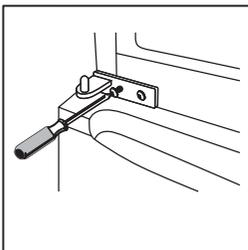
10. Установите верхнюю дверь. Перед окончательным затягиванием верхней петли убедитесь, что дверца выровнена по горизонтали и вертикали таким образом, чтобы уплотнитель прилегал со всех сторон. Затем вставьте петлю, и прикрутите ее к верхней части блока.
