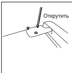
3. С помощью отвертки снимите штифт и переверните шарнирный кронштейн. Затем установите штифт на шарнирный кронштейн.
