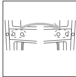
6. Открутите нижнюю петлю. Затем снимите регулируемые ножки с обеих сторон.
