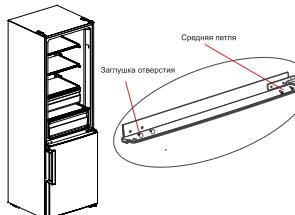
3) Снимите дверь холодильной камеры, среднюю петлю (винт средней петли откручивается при помощи ключа-шестигранника), извлеките заглушки отверстий с противоположной стороны.
