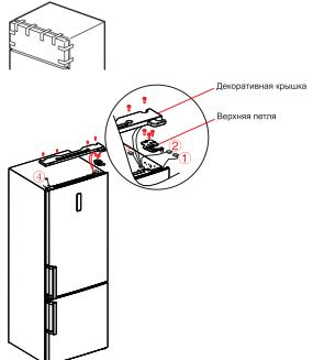
2) Снимите верхнюю декоративную крышку, винты и верхнюю петлю, отсоедините провод в правой части холодильника.
