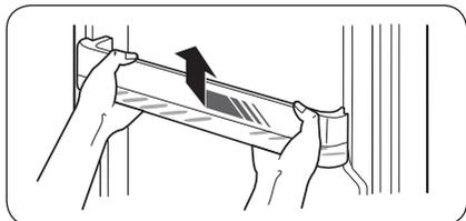
Слегка приподнимите и извлеките дверной лоток.
