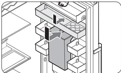
3. Установите резервуар для воды на место, после чего установите верхнюю перегородку. Вставьте резервуар для воды в дверь в вертикальном положении и опускайте, чтобы он встал на место. Не наклоняйте резервуар для воды.
