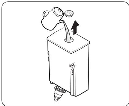
2. Залейте в резервуар для воды не более 4,5 литра воды. Залить воду можно, сняв либо крышку резервуара, либо колпачок отверстия для заливки воды.
