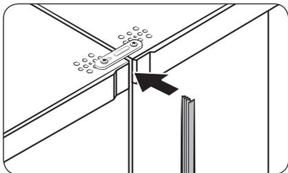
4. Сделав зазор, вставьте один конец пластины между верхними передними крышками двух холодильников.
