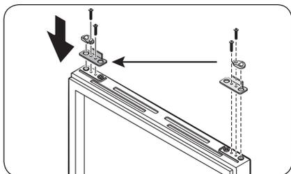
1. Удалите рычаг механизма автоматического закрывания на дверце холодильной камеры, вывинтив винты на рычаге и винты на противоположной стороне дверцы.
