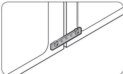
3. Соедините ножки двух холодильников с помощью **усиленной нижней петли** и **шурупов**.
