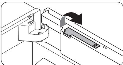
1. Откройте дверцу холодильной камеры и поднимите крышку интеллектуального устройства в верхней части дверцы.
