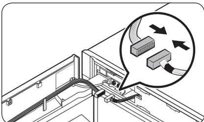
7. Соедините соединители дверцы холодильной камеры и основного блока. Затем зафиксируйте провода внутренним крюком дополнительной крышки петли (Л).
