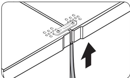
5. Протолкните пластину вверх до упора.
