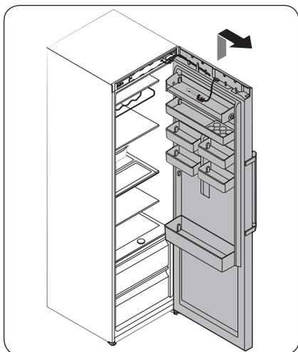
4. Удалив **верхнюю петлю**, приподнимите и снимите дверцу холодильной камеры. Поставьте дверцу в безопасном месте.
