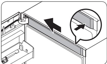
10. Вставьте **крышку проводов** через открытую **крышку интеллектуального устройства**. Поверните крышку на 90 градусов и нажмите на нее, чтобы установить на место.
