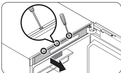
1. Вставьте плоские отвертки в верхние отверстия одну за другой, чтобы снять **верхнюю крышку рамы**.
