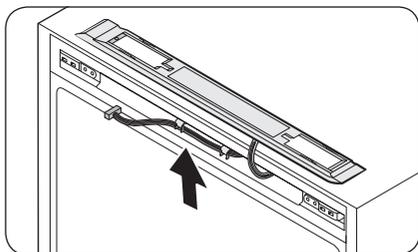
2. Переместите провода и соединители в противоположную сторону. Вставьте крышку панели управления и затяните винты с противоположной стороны.
