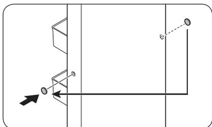
3. Удалите **заглушки винтов ручки** (2 шт.) с помощью плоской отвертки. Затем вставьте **заглушки винтов ручки** с противоположной стороны дверцы.
