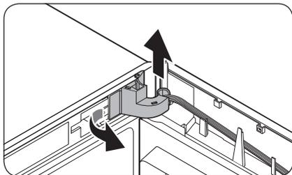
2. Потяните наружу левую часть **крышки петли**, а затем слегка приподнимите ее за нижнюю часть, чтобы вытащить крышку.
