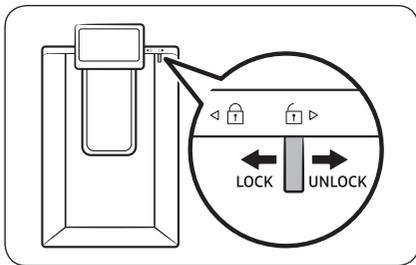
4. Диспенсердің су шүмегінің астына стакан қойып, стаканыңызбен су диспенсерінің тұтқасын абайлап итеріңіз. Су диспенсері бекітпесінің ашық екеніне көз жеткізіңіз.
