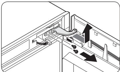
4. Удалив **верхнюю петлю**, приподнимите и снимите дверцу холодильной камеры. Поставьте дверцу в безопасном месте.
