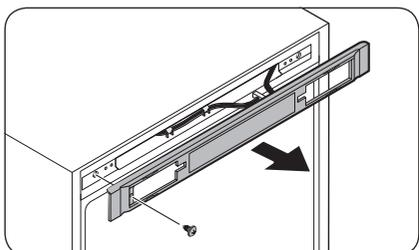
1. Открутите винт и вытяните **крышку панели управления**.
