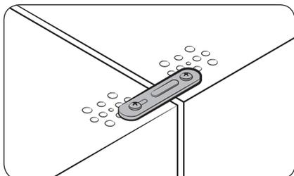
1. Соедините верхние части двух холодильников с помощью **соединительной пластины** и **шурупов**.
