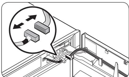
3. Отсоедините соединители, расположенные на дверце холодильной камеры или рядом с ней. Вывинтите винты **верхней петли**, чтобы снять ее.
