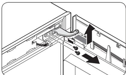
1. Сначала снимите **верхнюю крышку рамы** справа. Затем потяните крышку вперед.
