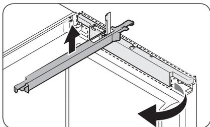
3. Поверните крышку проводов на 90 градусов, после чего направленным вверх усилием снимите ее.
