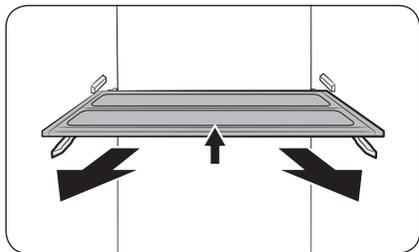
1. Слегка приподнимите переднюю часть полки, чтобы вытащить ее.
