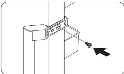
1. Вставьте ручку с противоположной стороны дверцы и затяните винт.
