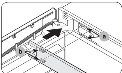
9. Вставьте **верхнюю крышку рамы** таким образом, чтобы **часть (b)** вошла в **часть (a)** по диагонали.
