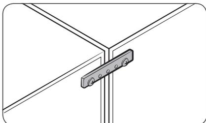
2. Соедините верхние и нижние задние части двух холодильников с помощью **усиленных задних петель** и **шурупов**.
