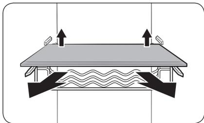
Слегка приподнимите заднюю часть полки (или полки для вина), чтобы вытащить ее.
