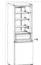
5) Снимите дверь морозильной камеры.
