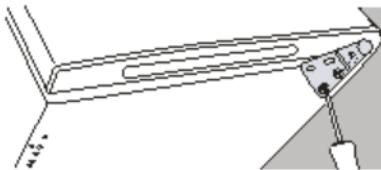
5. Установите петлю на холодильнике и закрепите двумя шурупами. Установите дверь на оси. Убедитесь, что дверь установлена правильно. Установите пластмассовую крышку на петле.
