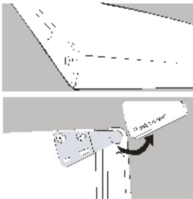
4. Снимите пластмассовую крышку с петли дверцы. Открутите два шурупа, переставьте петлю на другую сторону.
