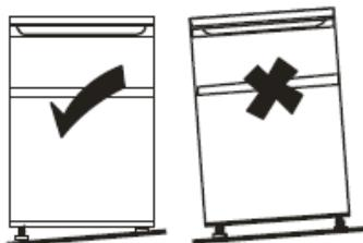
Для выставления холодильника по уровню, отрегулируйте высоту ножек в передней нижней части холодильника. Поворачивайте ножки по часовой стрелке, чтобы опустить соответствующий угол холодильника, против часовой стрелки – чтобы приподнять.
