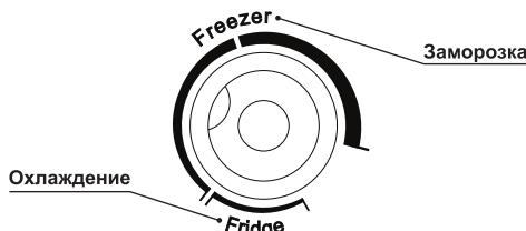
Расположение ручки термостата на пункте "Режим охлаждения" означает, что температура внутри выше 0°C.
