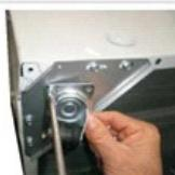
6. Колесики и ролики установлены.
