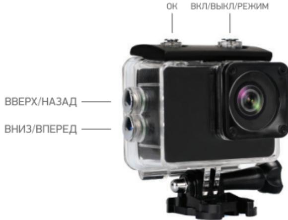
3. Поместите камеру с установленной microSD-картой и заряженной батареей внутрь бокса. Убедитесь, что камера вошла в бокс без перекосов и защемлений.
