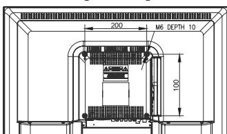
1. Используйте 4 установочных винта для крепления 2 устройств настенного крепления, оставляя между ними зазор в соответствующий размеру VESA.
