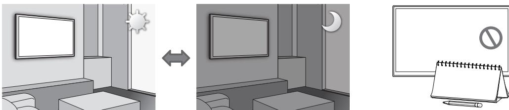
Датчик экономного режима автоматически регулирует яркость экрана телевизора. При активации этой функции определяется интенсивность освещения в помещении, и с целью снижения потребления энергии автоматически оптимизируется яркость экрана. Чтобы отключить эту функцию, перейдите к > **Настройки > Общие > Экономный режим > Обнаружение окружающего освещения**.
