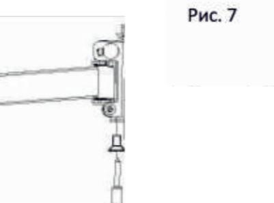
**ВНИМАНИЕ!** Запрещается полностью ослаблять или вынимать шуруп, фиксирующий угол наклона.
