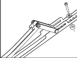
Установите крепления на задней стенке телевизора. Совместите отверстия на креплениях с отверстиями в задней стенке телевизора. Зафиксируйте крепления на телевизоре подходящими шурупами. Для установки креплений на телевизорах с неровной задней стенкой, Вам могут потребоваться прокладки. Используйте прокладки только в случае необходимости.
