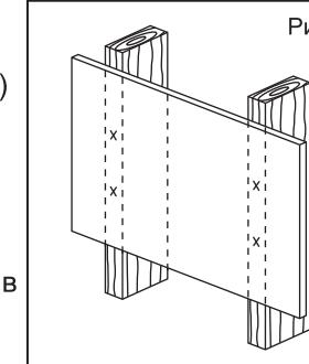
Нанесите четыре метки (по две на каждую балку) (рис.1) и отложите основание в сторону. Просверлите 6 мм. отверстие в каждой из отметок.
