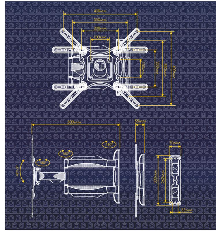
Кронштейн изготовлен из высококачественной холоднокатаной стали (SPCC)
