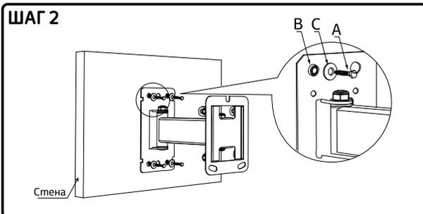
**ШАГ 2:** Установите площадку кронштейна для крепления к стене и закрутите через неё в проделанные отверстия с пластиковыми дюбелями шурупы **A** через шайбы **C** плотно прикрутив площадку к стене.
