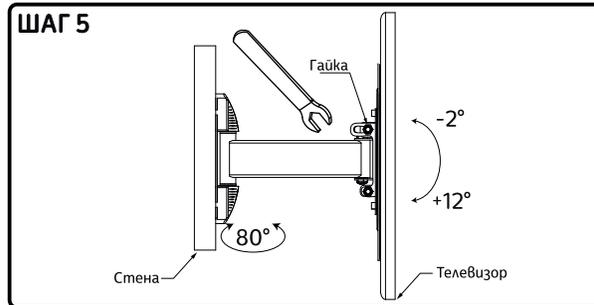
**ШАГ 5:** Кронштейн имеет возможность поворота влево и вправо на угол до 80°. Также имеется возможность наклона до 12°, для этого необходимо ослабить гайки с двух сторон кронштейна ключом **I**, отрегулировать наклон, затем снова их затянуть.
