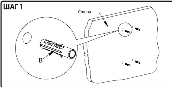
**ШАГ 1:** Приложите в желательном месте установки площадку крепления кронштейна к стене как шаблон для того, чтобы разметить места сверления. Используйте соответствующий инструмент со сверлом Ø 8мм, просверлив на глубину не более 50 мм. Затем установите в проделанные отверстия в стене пластиковые дюбели **B** из комплекта.
