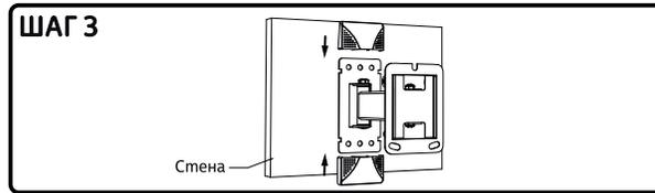
**ШАГ 3:** Установите до характерного щелчка сверху и снизу площадку крепления к стене по одной декоративной пластиковой накладке.
