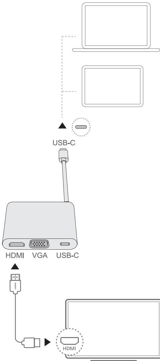
**1** Подключите компьютер к телевизору, монитору или проектору с помощью док-станции, как показано на нижеприведенном рисунке.
