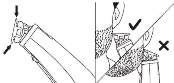
Если вам нужно оставить волосы определенной длины, используйте гребень. Сначала наденьте гребень на лезвия, а затем вставьте сторону гребня с регулятором длины в корпус триммера до щелчка, как показано на рисунке.
