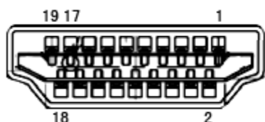
19-контактный кабель для передачи сигналов цветного изображения
